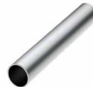
Buis 48.3x4mm (tek nr: 201407-107) Gewicht: ± 1.17 kg per meter Materiaal: AW-6060 50ST Figuur 11
