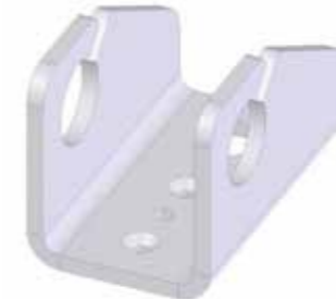
Scharnierpunt / Trekoog (tek nr: 201407-103) Materiaal: Aluminium AW 5754 ALMg 3 Gewicht: ± 0.67 kg Figuur 4
